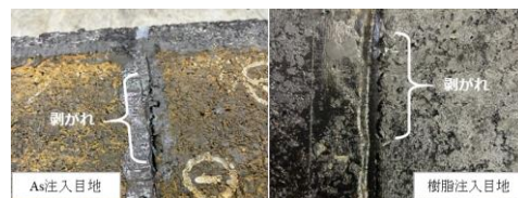
写真-1 試験後の供試体化
