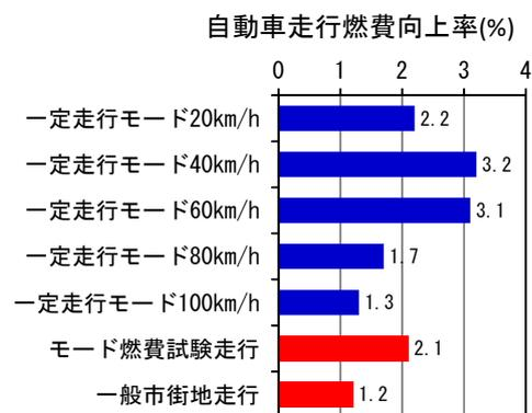
図-2 排水性(13)に対する低燃費型As(5)の自動車走行燃費向上率の試算結果
