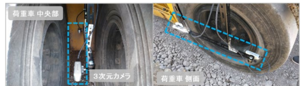
写真-4 3次元カメラの取り付け状況
