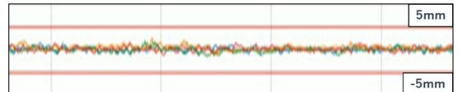
図-12 路盤でのセンター検出結果グラフ
