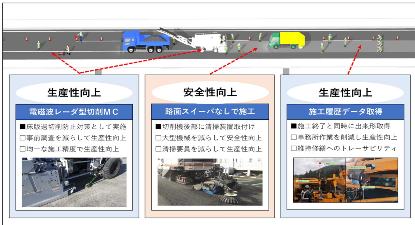
図-1 路面切削工 生産性向上策イメージ
