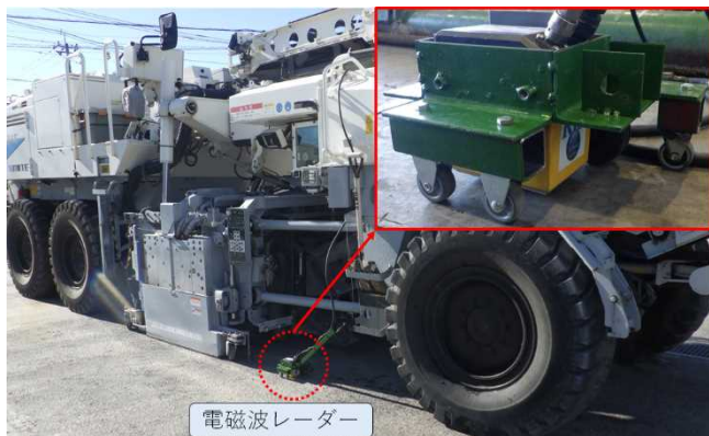
写真-7 電磁波レーダ切削機取付け状況
