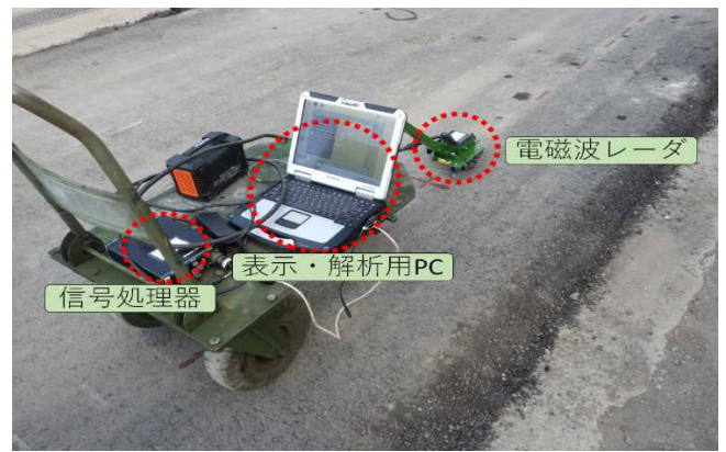
写真-6 電磁波レーダ性能確認状況
