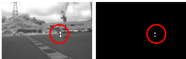
写真-5 小型カメラによる画像（左；処理前 右；処理後） ※、赤丸部が自発光マーカ
