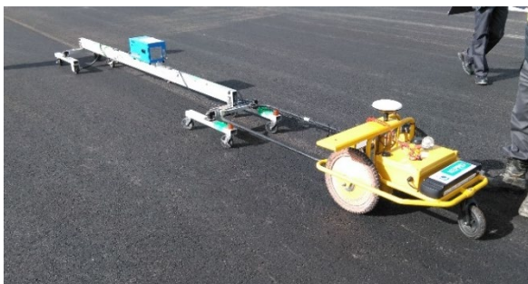
写真-9 自動走行ロボットによる 3m プロフィールメータのけん引状況
