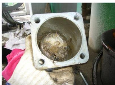
写真-6 凍結した燃料フィルタ
