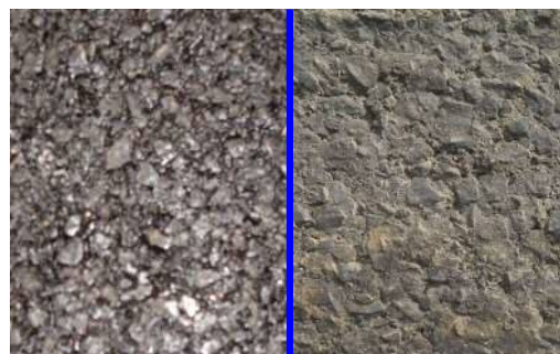
試験前 58,000 輪通過後 写真-2 試験前後の供試体表面のキメ
