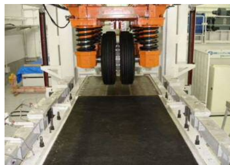
写真-1 実物大繰返し載荷試験機
