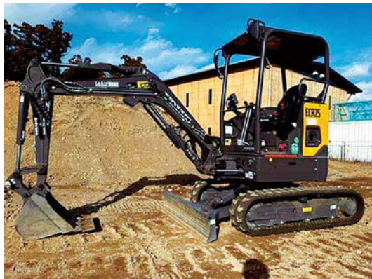
施工現場で使われるGX建機
