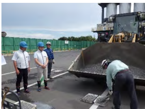
写真-2 技術検証委員会によるホップ及びホットビン骨材のサンプリング状況の確認
