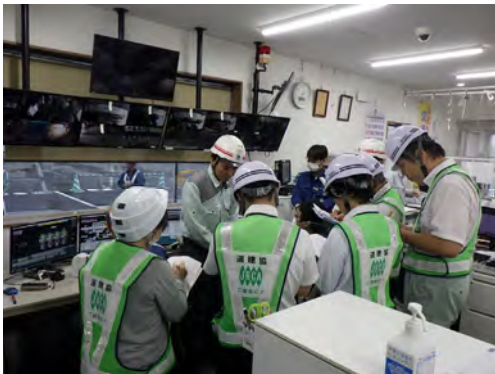
写真-7 道建協によるアスファルト合材製造時の操作盤設定値の確認
